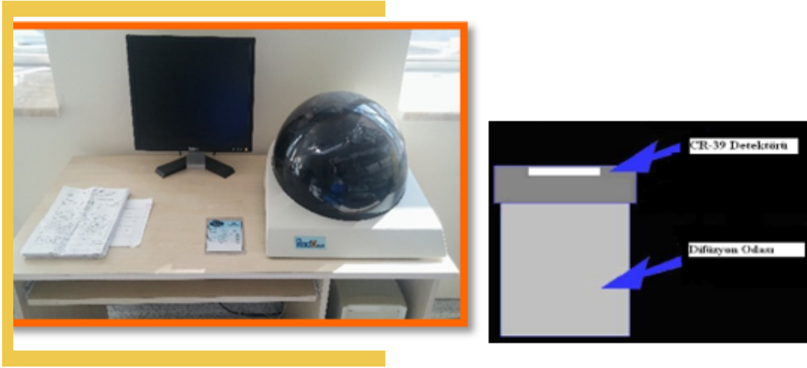
ŞEKİL 12.KATI HAL NÜKLEER İZ DEDEKTÖRÜ ÖLÇÜM SİSTEMİ VE CR 39 DEDEKTÖRÜ
