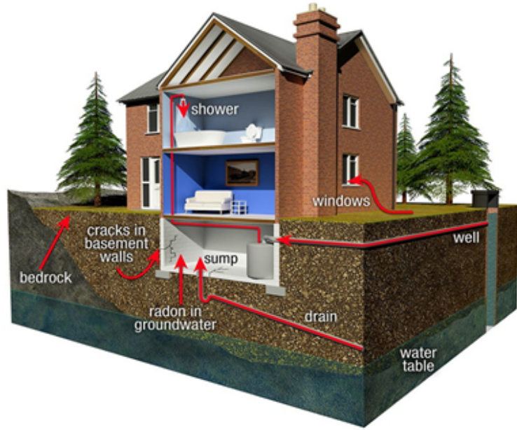
ŞEKİL 8. RADONUN BİNALARA GİRİŞ YOLLARI (KOYU RENK OKLAR İLE GÖSTERİLMİŞTİR [18].
